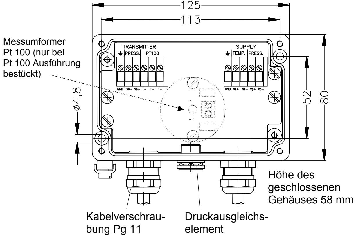
**Es ist bei der Installation unbedingt darauf zu achten, dass der Schutzleiter bei allen Komponenten angeschlossen wird !!**
