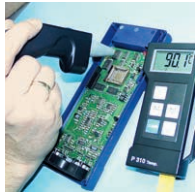
Kontrolle von elektron. Bauteilen mit Infrarotmessfühler (Best. Nr. 6010-0052) Messfleckgröße 2,5 mm
