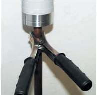
Temperaturmessung an Rohrleitungen (Fühler 6010-0067)
